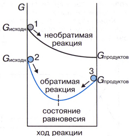
Рис. 34. Изменение энергии Гиббса в необратимой и обратимой реакциях
